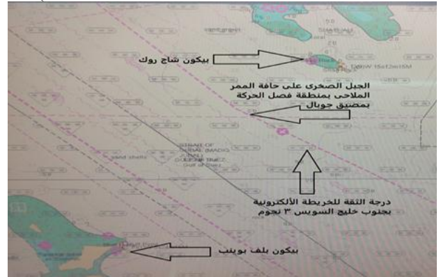
شكل رقم (٨) درجة الثقة للخريطة الإلكترونية بمنطقة مضيق جوبال بجنوب بخليج السويس المصدر: تصوير من جهاز Transas ECDIS أثناء الإبحار للسفينة عايدة/٤ (٢٠٢٠/٨)
