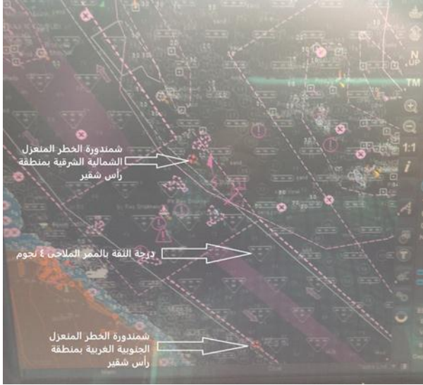
شكل رقم (٧) درجة الثقة للخريطة الإلكترونية بمنطقة رأس شقير بخليج السويس المصدر: تصوير من جهاز Transas ECDIS أثناء الإبحار للسفينة عايدة/٤ (٢٠٢٠/٣).
